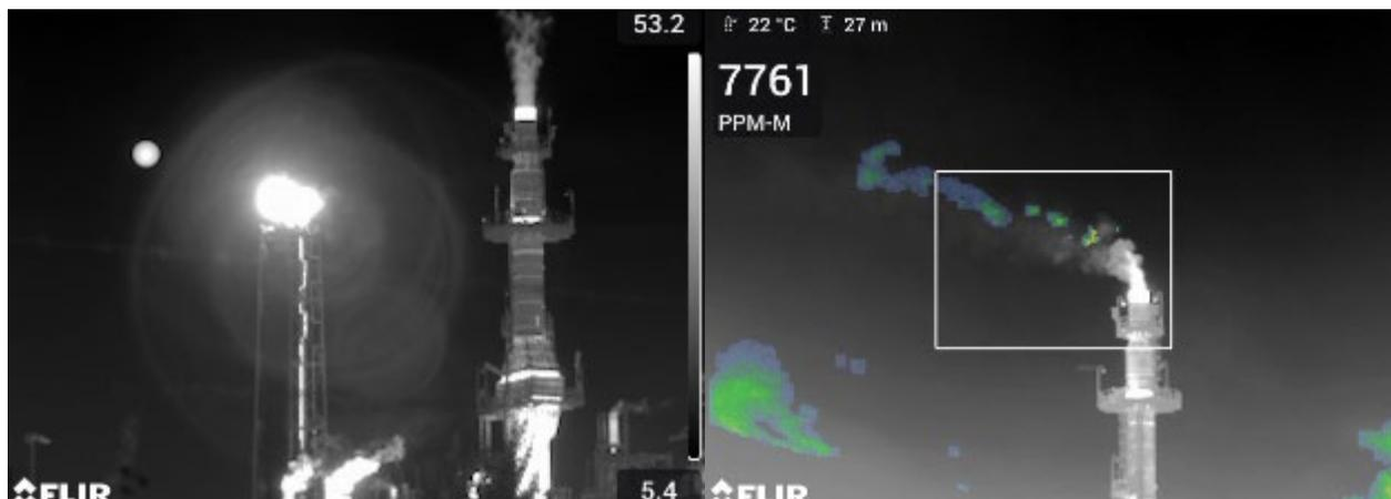
All'infrarosso la torcia del COVA appare molto più grande che nella realtà. Visibili anche le emissioni del camino della V linea gas con la rilevazione di oltre 7000 ppm/minuto di metano
